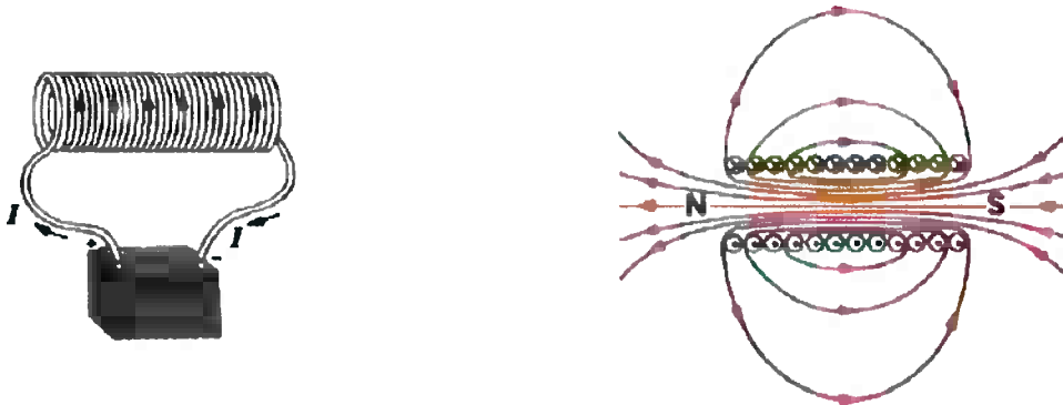
Fig. 11 – Bobina com corrente e campo magnético gerado
